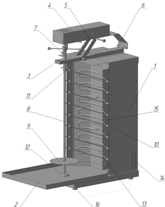
Шаурма-шашлычница электрическая представляет собой конструкцию коробчатой формы. Впереди на корпусе (1) см. рис. 1 установлены 2 ТЭНа (ШШЭ-2 и ШШЭ-2-М) или 3 ТЭНа (ШШЭ-3 и ШШЭ-3-М) (13). С боков корпуса установлены направляющие для горизонтальных шампуров (15). Клавиши включения (14) расположены на правом боку корпуса.
