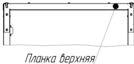
Рис.2 Установка стяжки (Вид изнутри шкафа)
