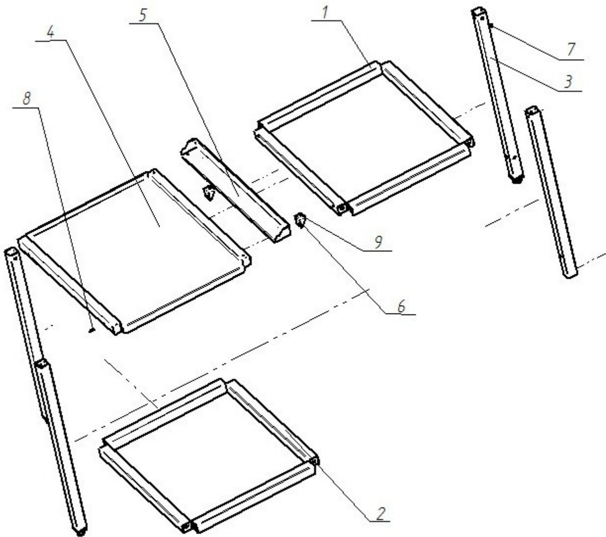
Рис. 1 Разнесенная сборка стола СПМР-6-2
