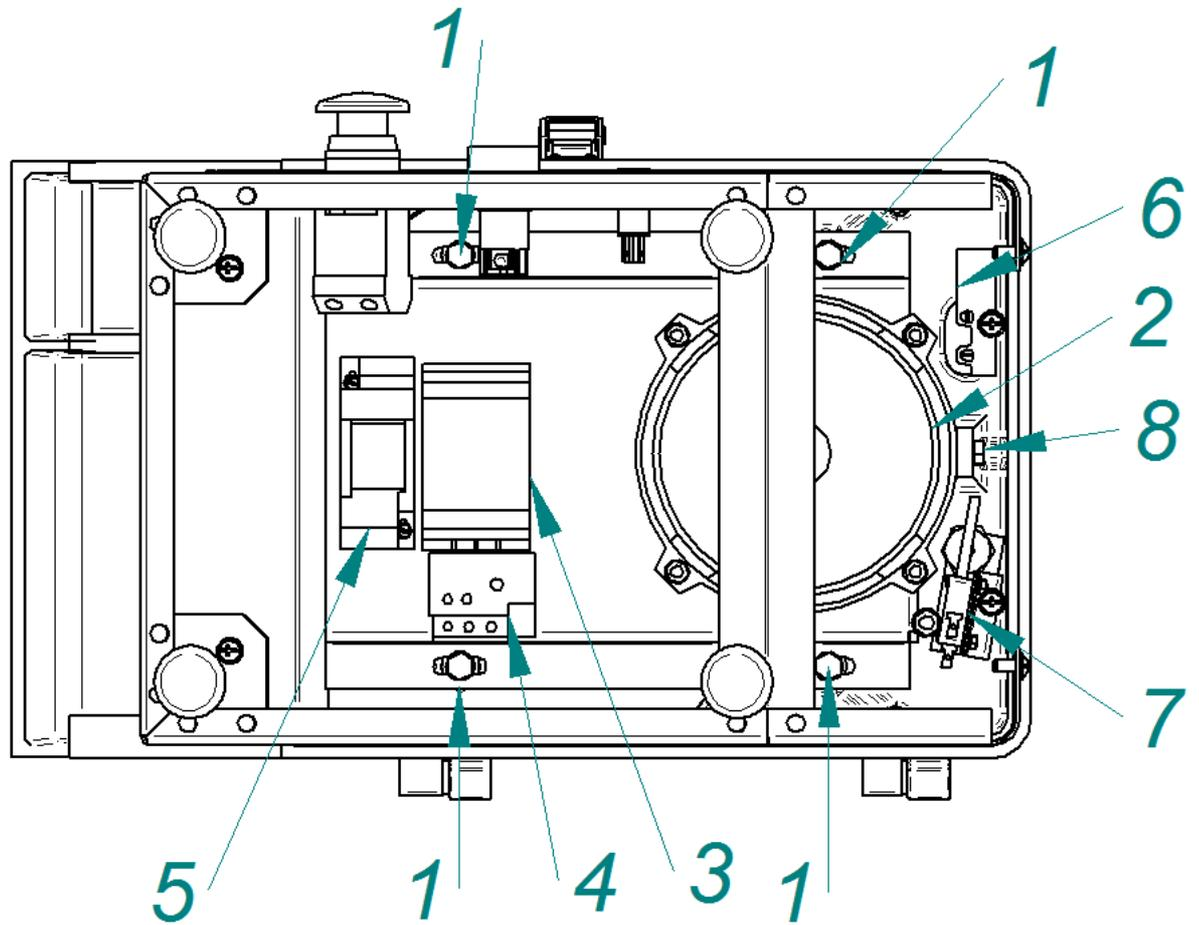
1. Болты крепления кронштейна установки электрооборудования.
