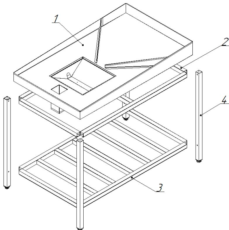
1. Установить стойки (поз. 4) в квадратные гнезда верхней рамы (поз. 2), соединенной со столешницей (поз. 1), и соединить их с помощью болтов М6.
